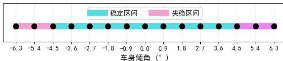
图6 自行车机器人姿态稳定范围示意图
